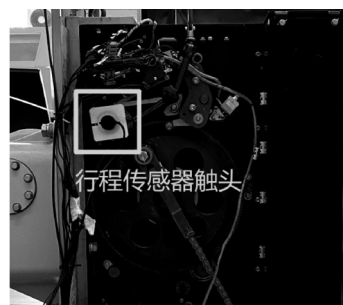
图12 行程传感器安装示意图
